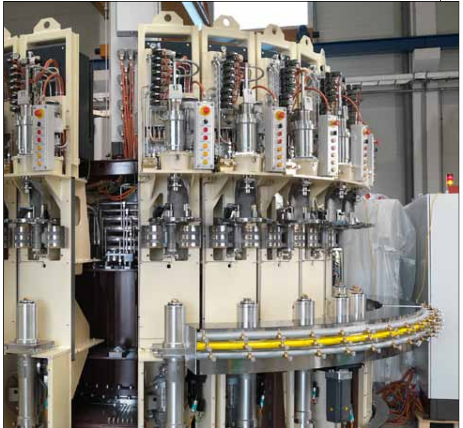
Autarke Stationen: Bei einer Störung können binnen maximal zehn Minuten einzelne Segmente der Blasmachine ausgetauscht werden. Das reduziert die Stillstandszeiten enorm.
