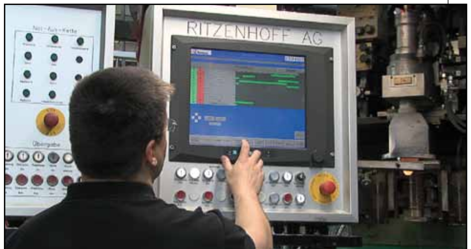
Einfache Handhabung: Sämtliche Ereignisse der Maschinenstationen werden in einem Balkendiagramm dargestellt und können bei Bedarf auch per Touchscreen angepasst werden.
