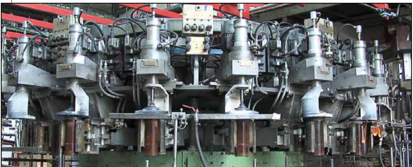
Glasproduktion im Stammwerk in Marsberg: Für Kunden aus der Getränkeindustrie und Gastronomie produziert Ritzenhoff Cristal auf seinen Rundläufermaschinen Gläser in großen Stückzahlen sowie limitierte Exklusivserien.
