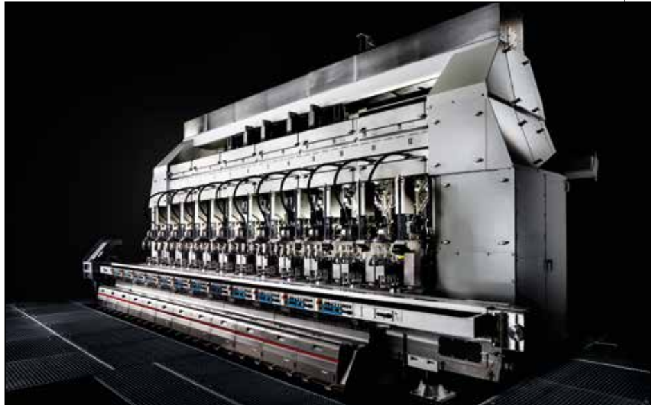
Moderne Glasfertigung: Die SpeedLine-IS-Maschinen von Heye versprechen hohe Produktivität und Qualität in der Behälterglasproduktion - natürlich mit Steuerungen von futronic.
